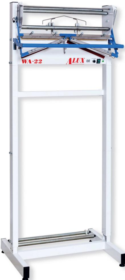
Urządzenie do pakowania produkowane w wersji wiszącej (WA-22w), stojącej (WA-22s) oraz stojącej automatycznej (WA-22p). Posiada elementy zgrzewające i tnące folię oraz regulację czasu klejenia.
