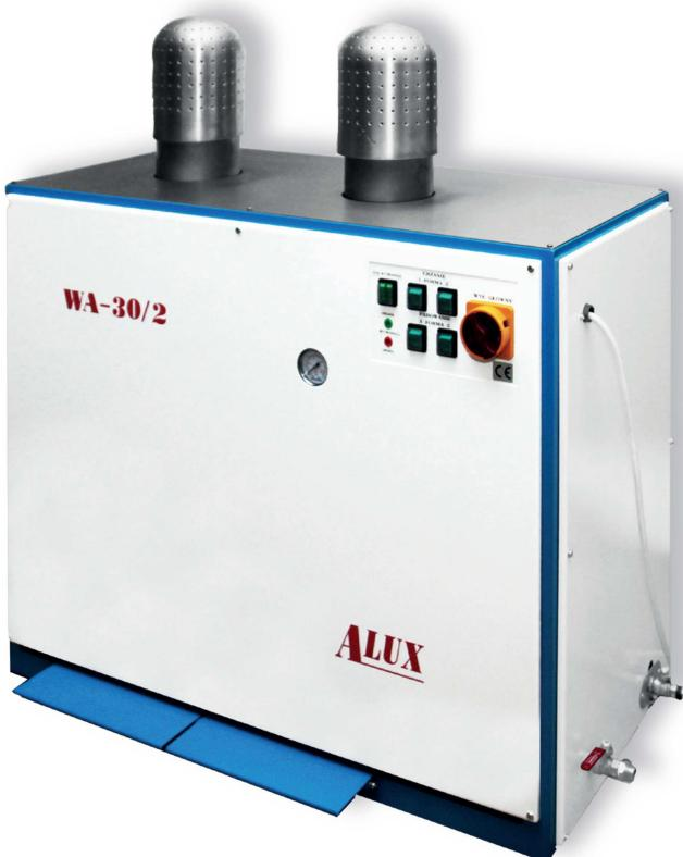
Urządzenie WA-30 skonstruowano z myślą o prasowaniu czapek. Urządzenie posiada odsysanie, grzanie oraz parowanie z formy prasovalniczej i produkowane jest z wbudowaną wytwornicą pary lub na obcą parę. Dostępne są różne kształty i wymiary form, również według indywidualnego zamówienia. Formy stabilizacyjne są podgrzewane elektrycznie.
