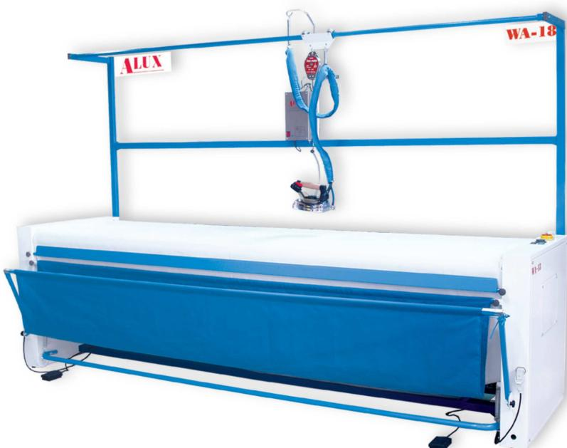
Stół prasowalniczy specjalistyczny przeznaczony do prasowania firan oraz zasłon ze względu na duże wymiary blatu oraz specjalne półki na materiał. Wyposażenie stołu stanowi system odsysania powietrza, podgrzewany blat z regulacją temperatury oraz **automatyczny przesuw materiału** na blacie. W wyposażeniu standardowym znajduje się również wygodne ruchome podwieszenie żelazka. Na życzenie stół produkowany jest również w wersji z nadmuchem powietrza.
