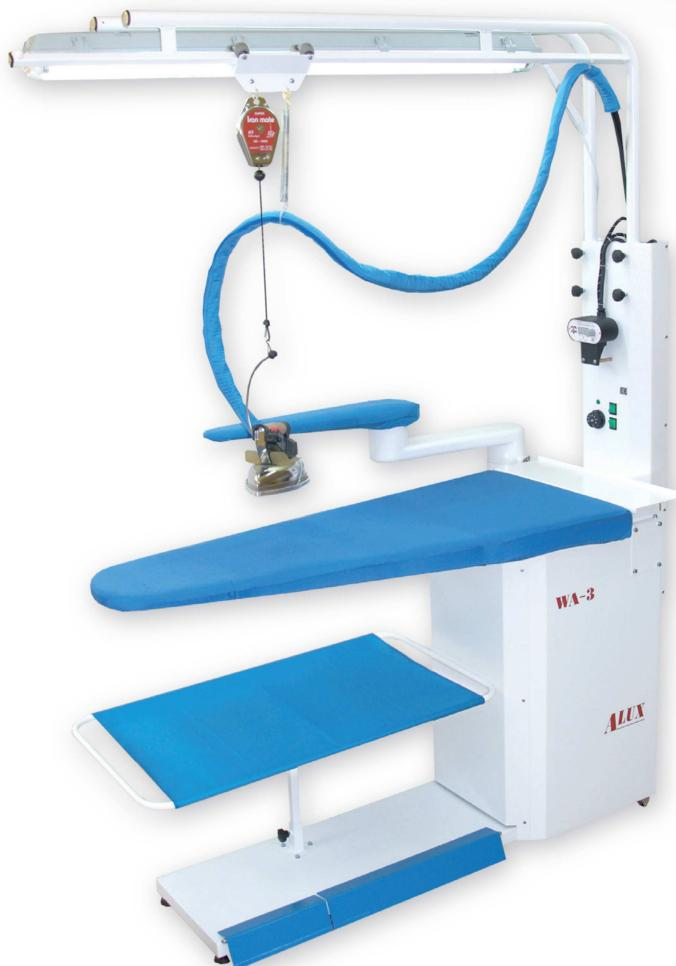
Stół prasowalniczy z odsysaniem i nadmuchem powietrza, regulowaną temperaturą blatu i automatycznym przełączaniem odsysania/nadmuchu na formę. WA-3n posiada pneumatycznie przełączane przepusty i produkowany jest również z regulacją wysokości blatu.
